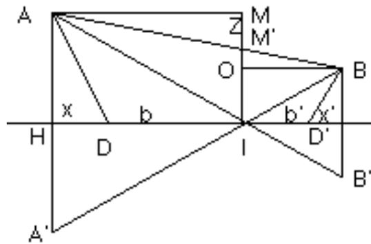
$Z$  est la distance de  $M$  à  $M'$  et  $y$  celle de  $M'$  à  $O$ .  $AMIH$  et  $BOIH'$  sont des rectangles. Les deux droites  $(AA')$  et  $(BB')$  toutes deux perpendiculaires à  $(HH')$  sont parallèles. Les deux triangles  $AA'I$  et  $BB'I$  sont donc semblables d'après le théorème de Thalès.
