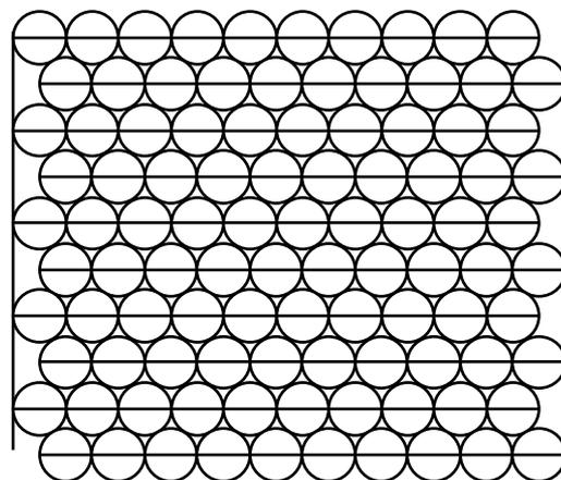
Dans le cas où les disques sont décalés (figures 2 et 3), on désigne par  $h$  la hauteur du décalage, gagnée par le chevauchement et  $H$  la distance qui sépare les droites sur lesquelles sont disposées les centres des disques de 2 rangées de même ordre (pair ou impair).
