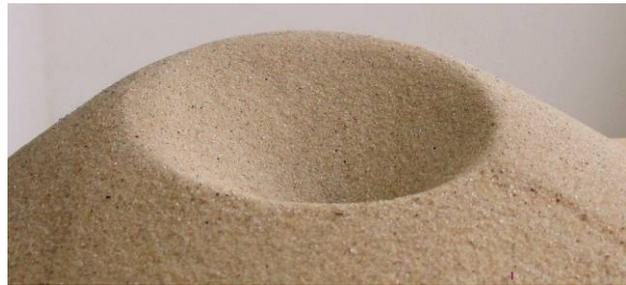
Quand le sable a retrouvé sa position d'équilibre, nous avons deux cônes : l'un est plein (en vert), l'autre est un cône vide (en rose). C'est deux fois le même cône : même angle de base et leurs axes sont parallèles puisque par gravité, l'entassement et l'écoulement se font verticalement.
