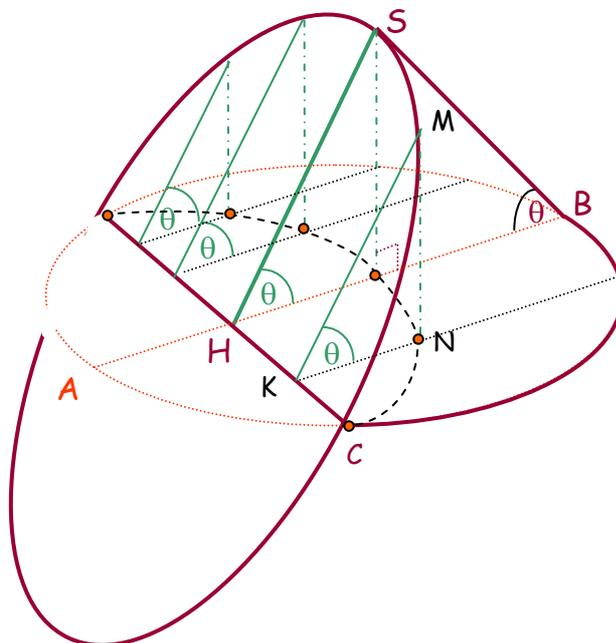
Ce qui démontre que la ligne de crête est plane et le plan qui la contient, contient aussi la corde de coupe. Cette ligne de crête est bien l'intersection d'un cône et d'un plan : c'est une conique. Mais quel type de conique ? Un cercle ? Une ellipse ? Ou autre chose que nos professeurs appellent parabole (voir II-3).
